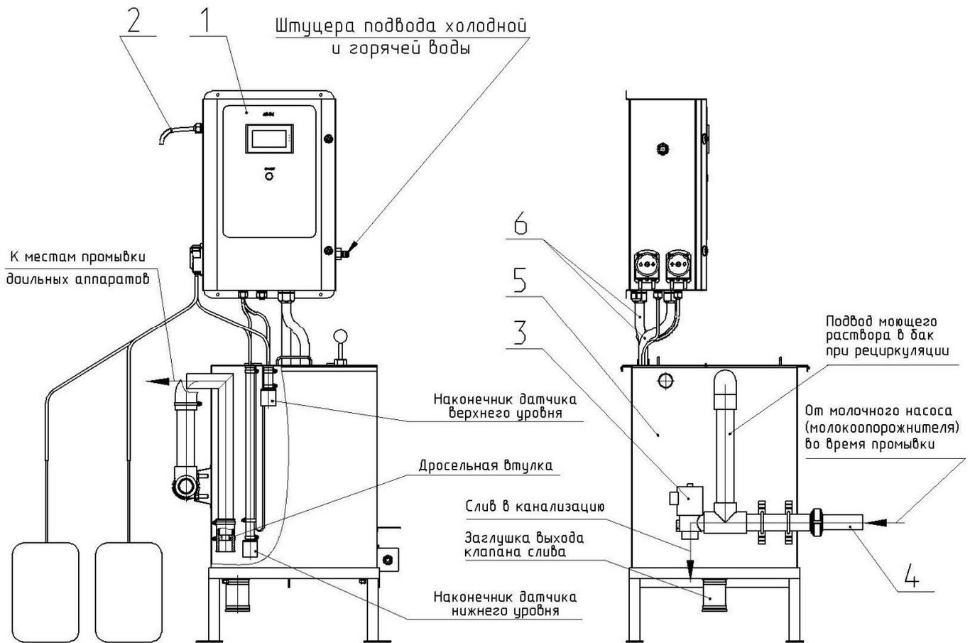
1 - Автомат промывки АП-1М; 2 - вводной кабель автомата промывки; 3 - клапан электромагнитный 2-х ходовой (поставляется в комплекте автомата промывки АП-1М); 4 – разборный соединительный патрубок (диаметр 45мм); 5 – бак; 6 - соединительный трубопровод.
